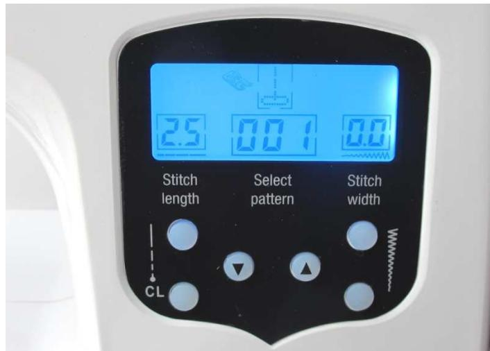
Allumer la machine. La machine montre le point droit 001.
